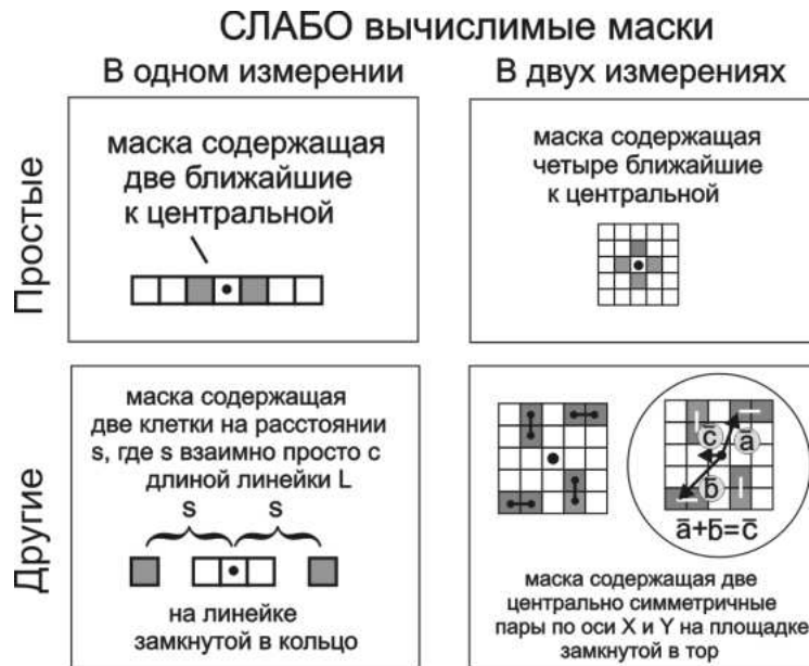
Рис. 1.5. СЛАБО вычислимые маски в одном и двух измерениях.
